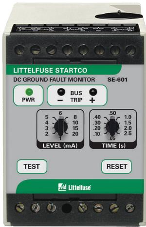
**图2.** SE-601直流接地故障监测仪提供灵敏快速的防误跳闸接地故障保护。使用SE-GRM系列接地参考模块（一种将接地故障电流限制在25 mA的电阻网络）来感测接地故障电流。SE-GRM允许将SE-601连接到高达1200 Vdc且可能更高的系统。
