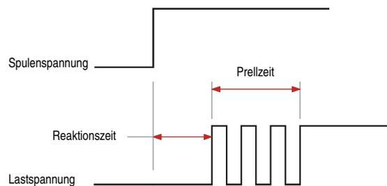
Abbildung 4 zeigt die Relation zwischen Ansprechzeit und Kontaktprellzeit bei EMRs. Die Ansprechzeit ist definiert als diejenige Zeit, die zwischen Einschalten der Spule und ersten Schließen des gewöhnlich offenen Kontakts vergeht. Bei mehrpoligen Schaltern endet die Ansprechzeit nach dem ersten Schließen des letzten Schaltkontakts. Die Prellzeit ist nicht in der Ansprechzeit enthalten. Ein Entwickler kann die Betätigungszeit durch Übersteuerung verringern.
