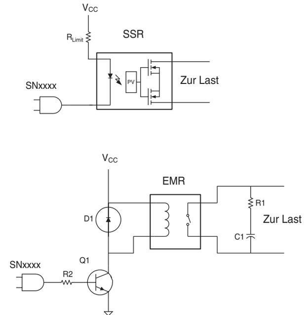
Wegen diesen Nachteilen müssen Entwickler die gebräuchlichen Kompensationspraktiken anwenden. Durch die Eingangsspule entsteht bei allen EMRs ein induktiver Stromspike beim Ausschalten, dem auch die empfindlichen Ansteuerbauelemente ausgesetzt sind. Der Spike kann gewöhnlich die Ansteuer-schaltung zerstören, wenn er nicht richtig unterdrückt wird. Um dieses Risiko auszuschließen, muss die Spule mit einer "schnellen" Diode beschaltet werden.
