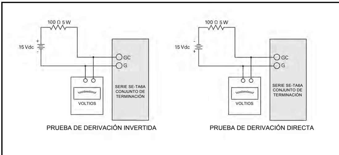
FIGURA 13. Circuitos de prueba de conjunto de terminación.
