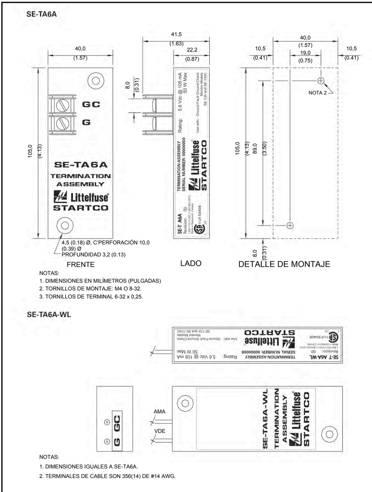
FIGURA 7. Conjuntos de terminación SE-TA6A y SE-TA6A-WL.
