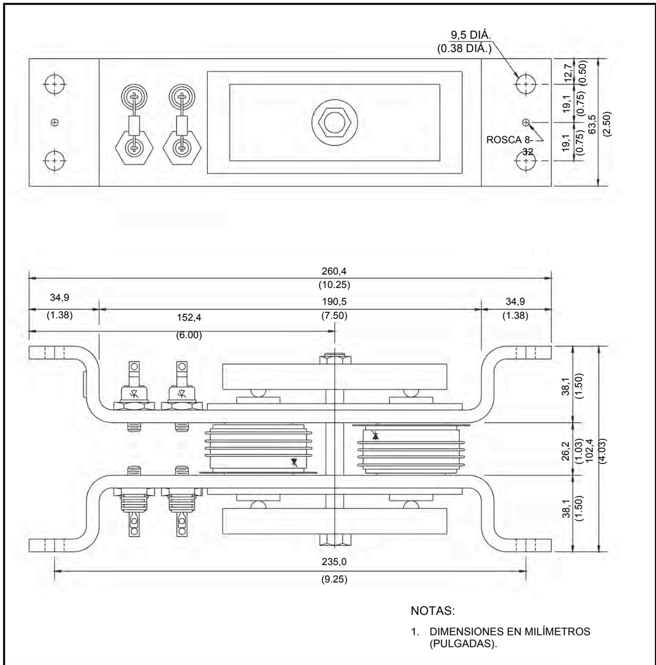
FIGURA 10. Aislador de ruta en paralelo PPI-600V.
